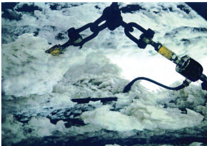
Измерение силы растяжения с помощью тензодатчиков серии С в условиях вечной мерзлоты
