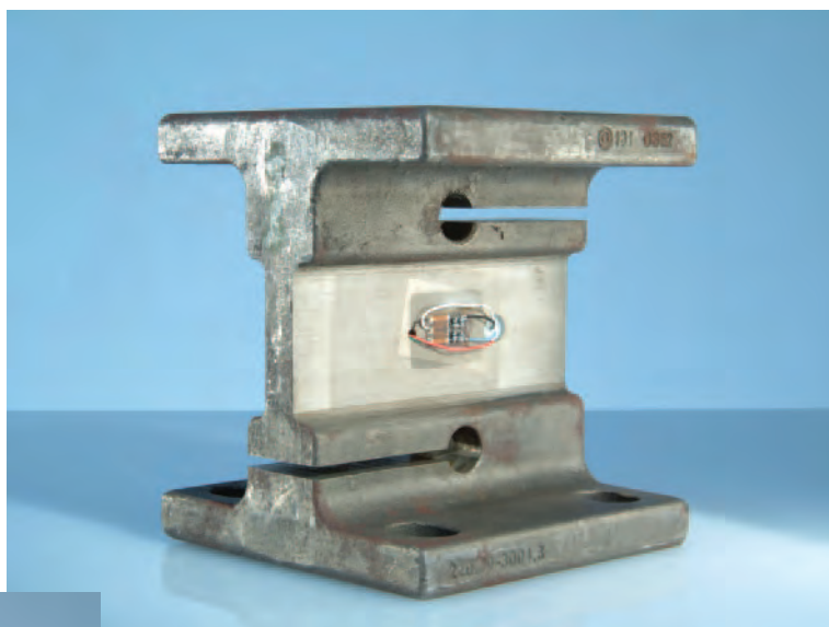
Установка тензорезистора на объект измерения
